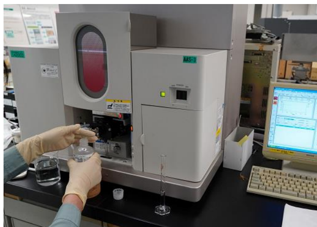
原子吸光による肥料成分の測定
