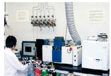
安定同位体比測定装置
