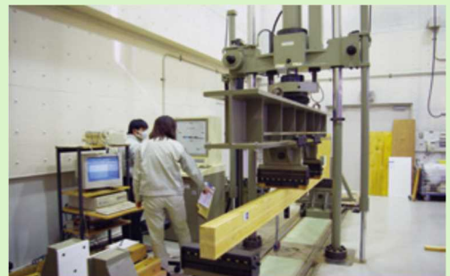
木質建材の品質に関する調査
