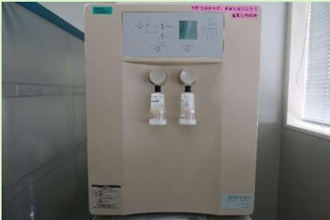
※純水製造装置は、水道水から蒸留、脱塩、脱イオン、RO(逆浸透膜)等の工程で不純物を取り除き、純度の高い水(純水)を精製する機器。
