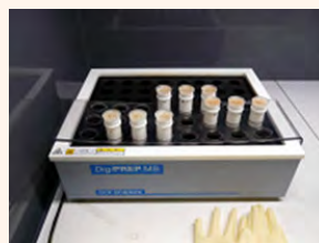
⑤硝酸等により、乾燥試料0.3gを分解する。
