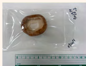
②柄を除き、圧縮空気を吹きつけ、傘部の木片等を除く（1個体が対象）。
