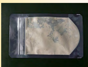
④凍結乾燥し、さらに細かく粉碎する。
