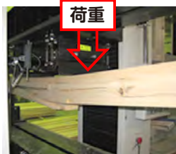
約2トンの荷重をかけたところで試験体が壊れました！ ①「E65-F255」の表示の場合、基準の目安は約1.3トン
