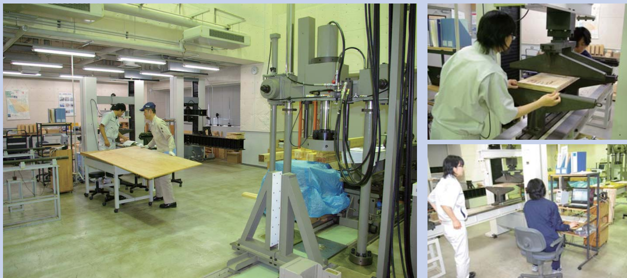
林産強度試験室 （左）試験材の表面を目視で確認したり、寸法を測ったりしています。 （右上）試験材の中央部に荷重をかけて、強度性能を調べています。 （右下）試験材のサイズや荷重スピードなどの設定をしています。
