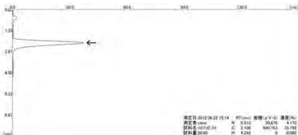
1) 検量線用標準品(DL-アスパラギン酸)中の炭素全量
